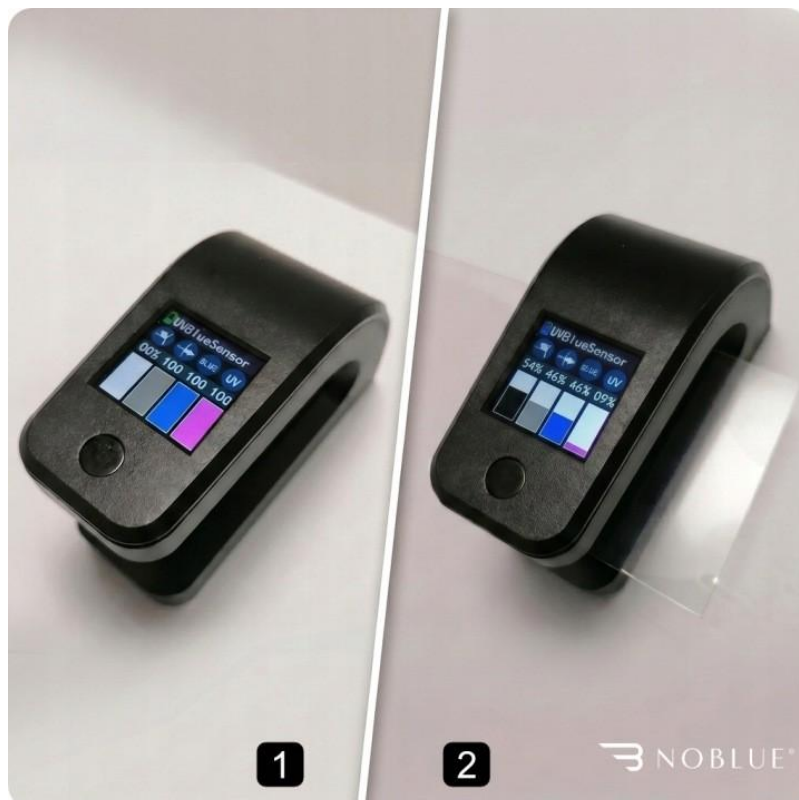
Fot. 1. Pomiar urządzeniem UWBlueSensor – bez filtra (1) oraz z filtrem NoBlue (2)
